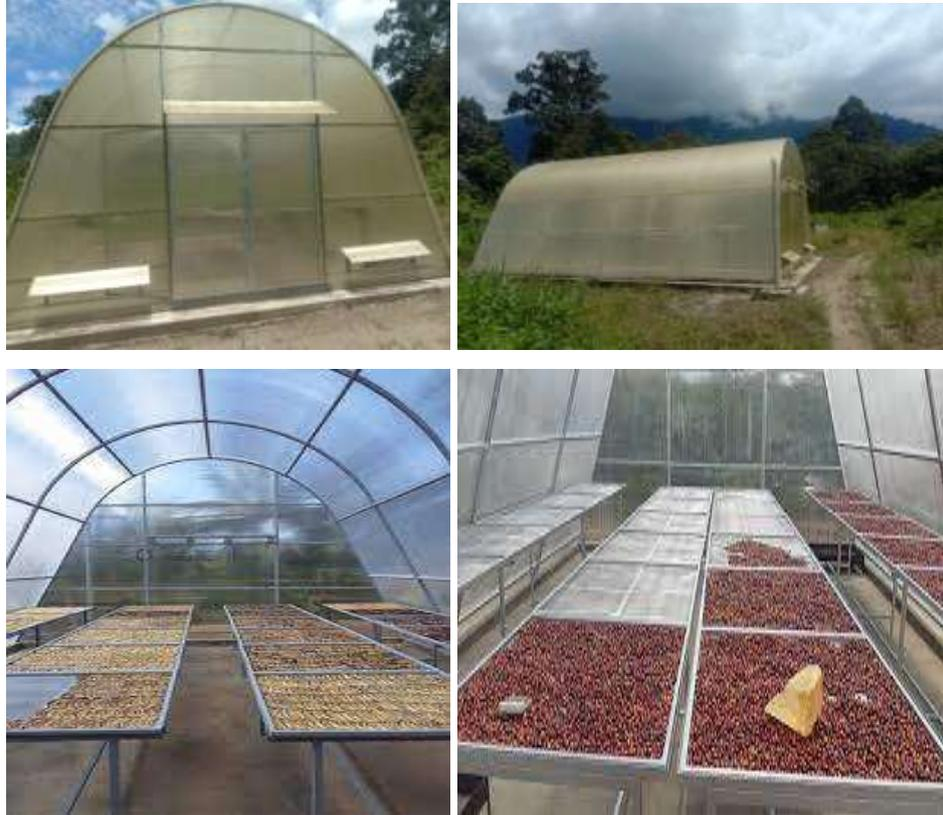
Gambar: Mesin pengering hasil panen
