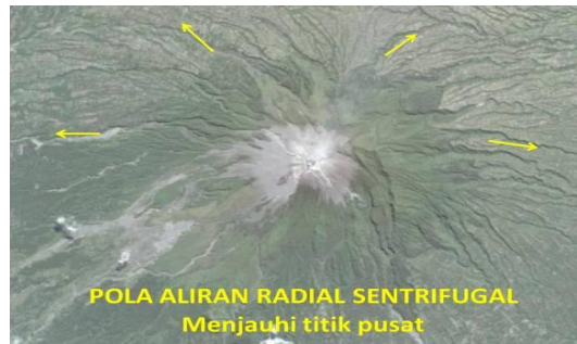
Contoh gambar pola aliran radial sentrifugal
